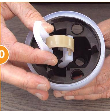
En el alineamiento del ensamble de la barra de presión, la parte curvada debe apuntar hacia adentro, y la barra de presión entra en al agujero individual. Acá es donde encaja la barra de conexión en el pistón.
