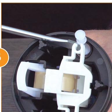
Para remover el motor y el ensamblaje soporte de la válvula de la cobertura del pistón, va a necesitar un destornillador de cabeza plana. Utilice el destornillador para remover las válvulas superiores. Las válvulas parecen puntillas de golf y saldrán fácilmente de la cobertura del pistón. Colóquelas a un lado.
