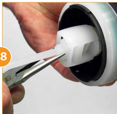
Reinstale el **Émbolo CHATEE** en [www.dosatron.com](http://www.dosatron.com) (**Parte #:** **PJDI138**) en la parte inferior de la cobertura del pistón. Usando las pinzas de punta delgada, dele vuelta en la dirección de las manecillas del reloj para asegurarlo.
