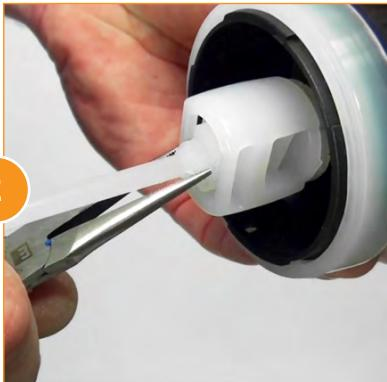
Sujete el émbolo con unas pinzas de punta delgada, cerca de la parte superior, y dele vuelta en contra de las manecillas del reloj para removerlo.
