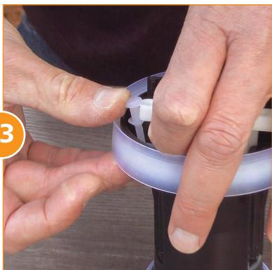
Inserte las válvulas superiores por la parte superior, encajándolas en el marco soporte.
