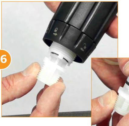
Instale la nueva **Válvula Cheque** (**Parte #:** **PJDI140**), en el vástago de inyección. Asegurese que está en la misma posición que se enseña en la imagen.
