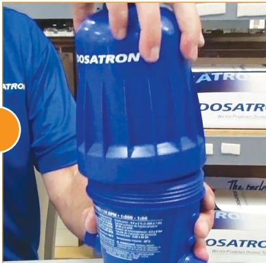
Comience removiendo el pistón de su inyector Dosatron. Desatornille y remueva la campana (tal vez necesite usar una llave de correa), ahora jale el pistón fuera del cuerpo. Coloque la campana y el cuerpo a un lado.
