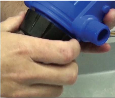
**Step 2:** Unscrew injection stem nut.
