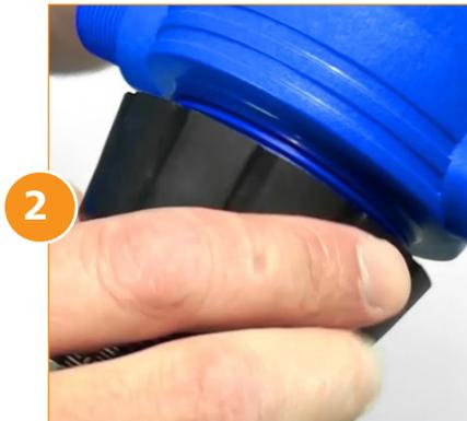
Desatornille la tuerca del vástago de inyección.
