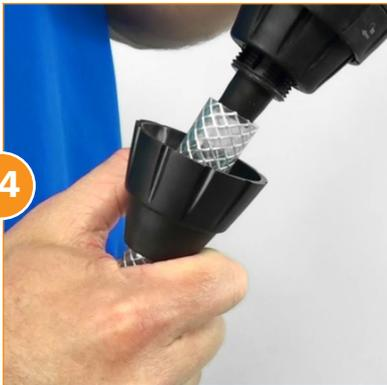
Inserte la manguera por la tuerca de la manguera de succión. Sujete la manguera a la lengüeta, y atornille la tuerca de la manguera.
