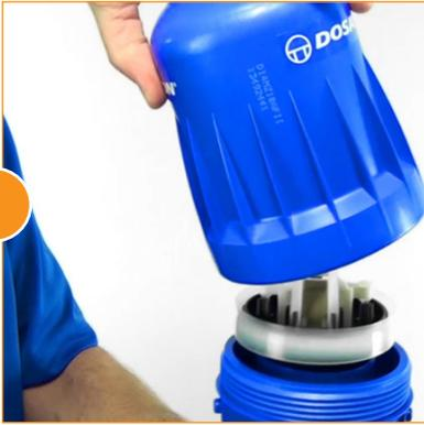
1 Comience removiendo el pistón de su inyector Dosatron. Desatornille y remueva la campana (tal vez necesite usar una llave de correa), ahora jale el pistón fuera del cuerpo. Coloque la campana y el cuerpo a un lado.
