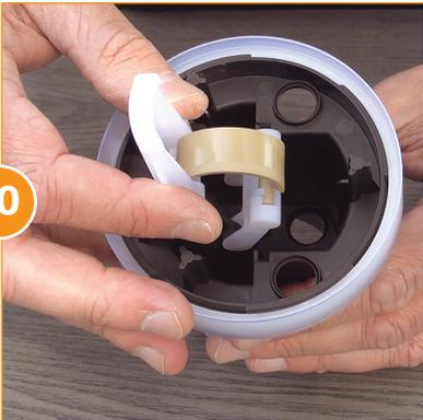
En el alineamiento del ensamble de la barra de presión, la parte curvada debe apuntar hacia adentro, y la barra de presión entra en el agujero individual. Aquí es donde encaja la barra de conexión en el pistón.
