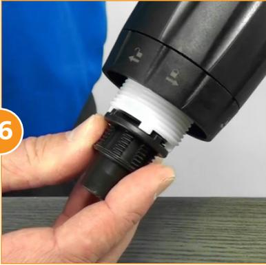
Instale la nueva **Válvula Cheque** (Parte #: **PJDI118**) dentro del vástago de inyección.
