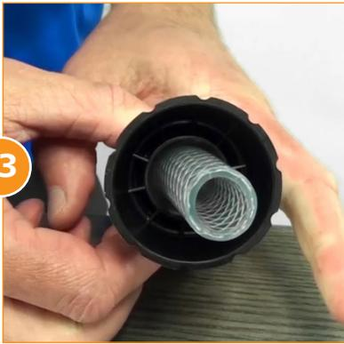
Antes de instalar la manguera de succión, inspecciónela. Si está ensanchada, córtela una pulgada más o menos y vuélvala a instalar.
