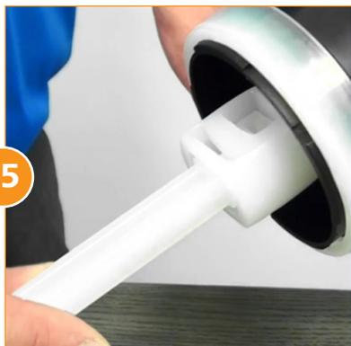
Reinstale el émbolo por la parte inferior de la cobertura del pistón, y dele un cuarto de vuelta en la dirección de las manecillas del reloj para encajarlo.
