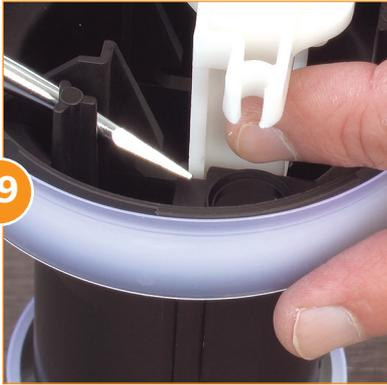
Asegúrese de que el ensamble soporte de la válvula encaja en el lado con los cuatro agujeros, y entra en las ranuras.
