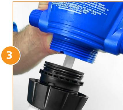
Jale el vástago hasta removerlo de la unidad. Coloque el cuerpo de la unidad a un lado.
