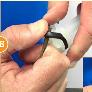
Sujete el cuerpo azul. Utilizando un destornillador pequeño de cabeza plana, remueva el **Empaque/Sello del Émbolo** (Parte #: **JDI123**). Instale el nuevo empaque/sello en la ranura del émbolo.
