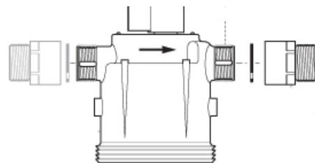
**! Recomendamos limpiar todas las partes con agua jabonosa y un cepillo de dientes antes de instalar las partes nuevas. El agua normalmente lubrica las partes, pero usted puede usar silicona en el anillo para facilitar su inserción. La válvula cheque se puede desarmar y limpiar entre mantenimientos para remover cualquier partícula.**
