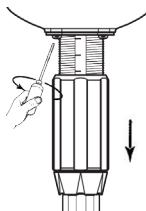
2. Remueva la tuerca de la manguera (PDI038) y la tuerca de la válvula cheque (PDI465), y colóquelas a un lado. Remueva la válvula cheque (**PJ114**), note la orientación de la lengüeta. Desatornille y remueva la tuerca de seguro (P168), remueva la arandela de fricción (P189). Empuje firmemente la barra blanca (PDI462) hasta removerla de la manga negra (P167).
