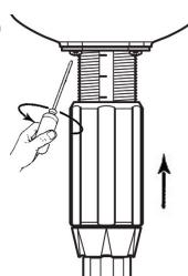
9. Desatornille los adaptadores de entrada y salida (P252). Remueva los sellos usados (**J534EP**) y reemplácelos con los nuevos incluidos en el kit. Atornille de nuevo los adaptadores (P252) en su lugar.
